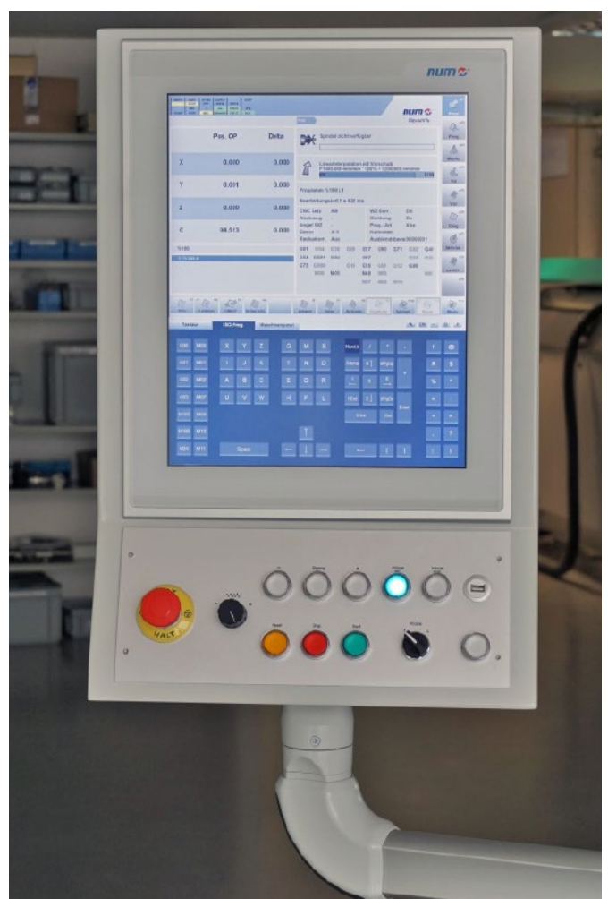
NUMs FS192i HMI, ergänzt mit einem selbstentwickeltem Bedienpanel von Felastec.
