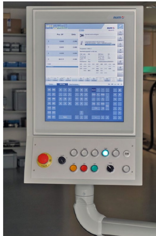
Le pupitre opérateur FS192i, complété par un pupitre machine développé par Felastec.
